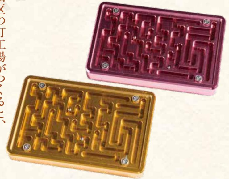
型抜きではなく、航空機や船舶などの精密な部品を製作する特殊な工作機械を使用して、アルミの塊から手間と時間をかけて削り出して製作した「迷路ゲーム」です。メッキやアクリルカバーは大田区内の町工場が協力しています。大田区の最先端をいくものづくり技術を身近に感じることができます。
